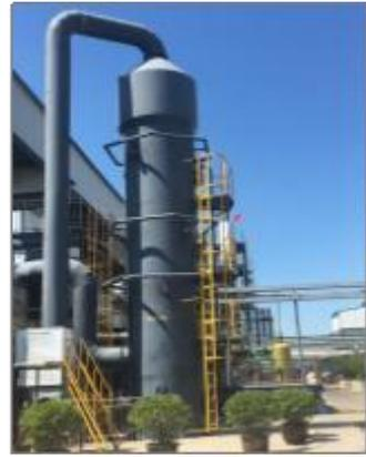
科迈天津2021年引进新的尾气吸附处理设施，实现尾气闭环处理。各造粒工序烘干产生的气体，增加催化光解环保设施以及喷淋吸收塔设施，对尾气进行进一步处理。工艺尾气采用2套焚烧炉进行焚烧处理，配意大利百得低氮燃烧器，实现安全自动控制。
